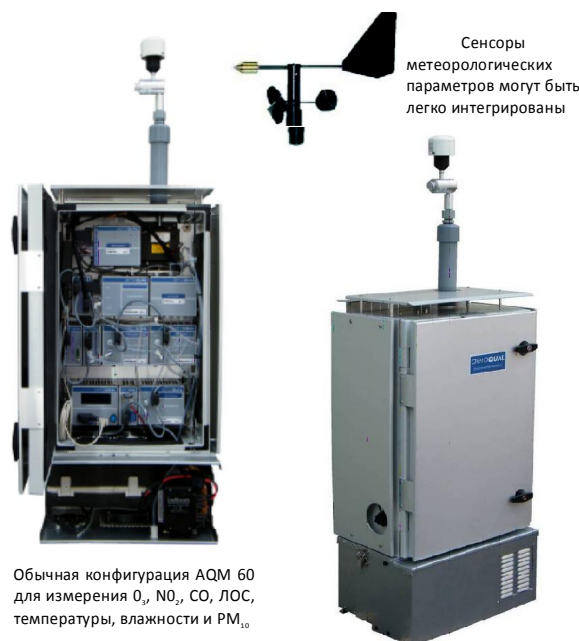
AQM 60 с Premium СТ с защитными панелями от солнечной радиации для работы в условия высокой температуры
