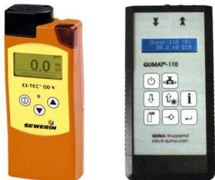
Портативные одориметры EX-TEC OD4 и Qumat-110 (производители германские, Hermann Sewerin GmbH и QUMA Elektronik & Analytik GmbH) — приборы с электрохимическими сенсорами. Фактически они определяют серу и только калибруются на определённые одоранты.
